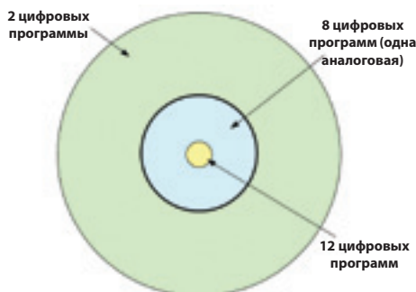
Рис.1. Относительные размеры зон приема (обслуживания) для сигналов DVB-T в зависимости от числа сервисов
